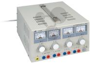
Netzgerät 0 - 500 V für Elektronenröhren
