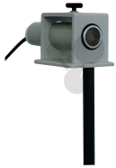
Halter für Ultraschallsender und -empfänger Bestellnummer 1132050
