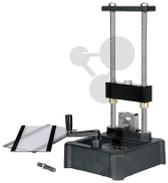
Gerät zur Messung der Zugfestigkeit von Materialproben
