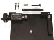
Grundgerät zur Zugfestigkeitsmessung
