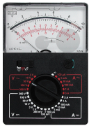
Analog-Vielfachmessgerät Nullpunkt Links / Mitte
