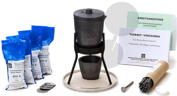
Die Verbindung zweier Metallteile im Thermit Schweißverfahren ist sowohl technisch als auch chemisch von großer Bedeutung. Die Reduktion von Eisenoxid mit Aluminium führt zu extrem hohen Temperaturen. Das reduzierte Eisen schmilzt und wird so in die Lage versetzt, zwei Metallenden bruchfest miteinander zu verschweißen. Mit dem Demo – Baukasten Thermit – Versuch ist die Möglichkeit gegeben, diese Reaktion gefahrlos zu demonstrieren.
