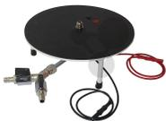
Luftpumpenteller mit Elektroanschlüssen
