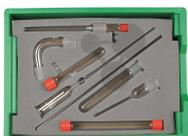
Bausatz Gasentwicklung Normschliff 24/29 Borosilikatglas
