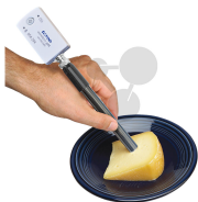
pH-Elektrode für nicht-flüssige Medien Bestellnummer 1184015
