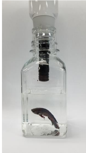
Abbildung 3. Kopfraummessung über einer Flüssigkeit
