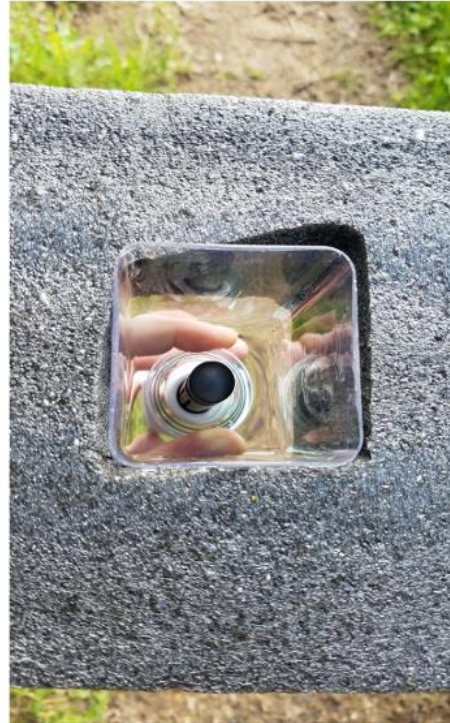
Abbildung 7. Mit einem Schaumstoff und einer zerschnittenen Flasche einen Luftraum schaffen und den Kohlenstoffaustausch messen.
