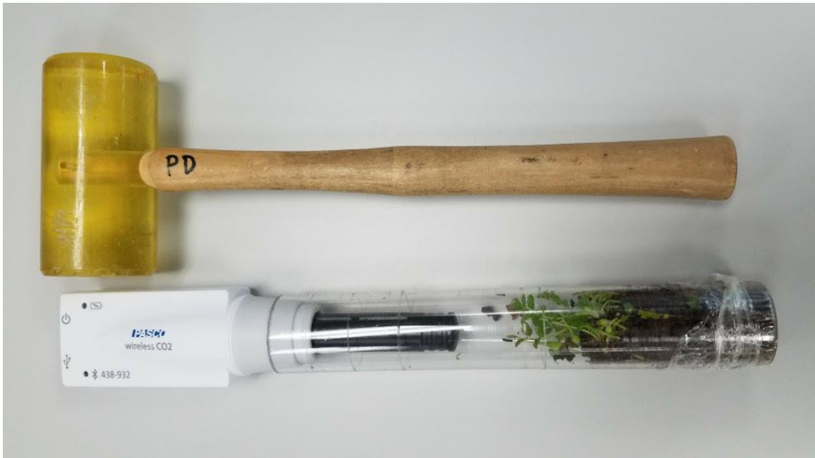
Abbildung 8. Sensor im PVC-Rohr mit Markierung für die Tiefe der Bodenprobe, klares PVC zur Demonstration.
