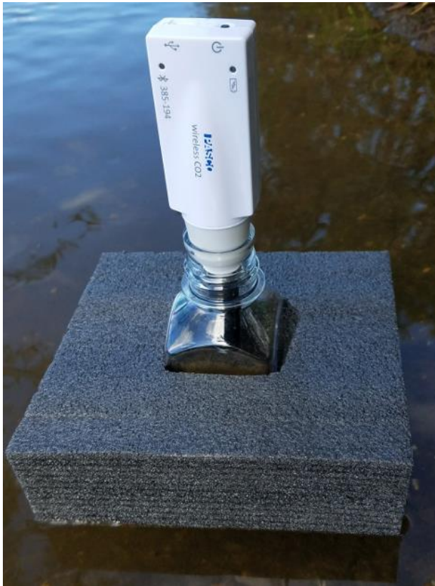
Abbildung 7. Mit einem Schaumstoff und einer zerschnittenen Flasche einen Luftraum schaffen und den Kohlenstoffaustausch messen.
