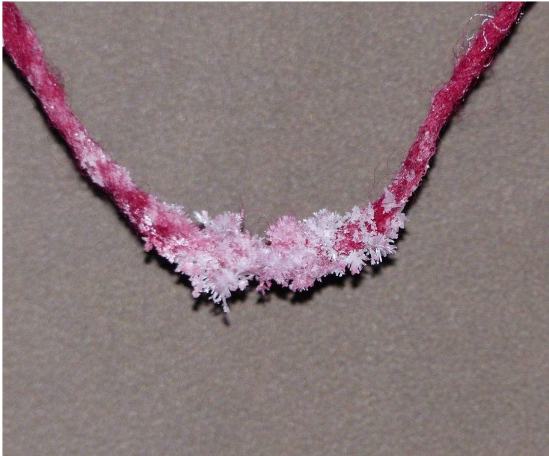
Abbildung 2: Vergrößerte Aufnahme der gebildeten Salzkristalle am unteren Ende des Wollfadenbogens
