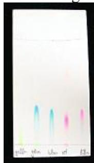
Jetzt stellen wir die DC-Platte in die DC-Kammer. Nach 25 min nehmen wir die Platte aus der Kammer und trocknen die Platte vorsichtig mit einem Fön.
