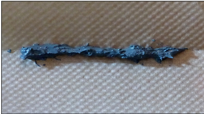
Bariumnitrat, Aluminium- und Kupferpulver in Kartoffelstärke mit wenig Wasser angerührt auf Backfolie ( nur Brennschicht)
