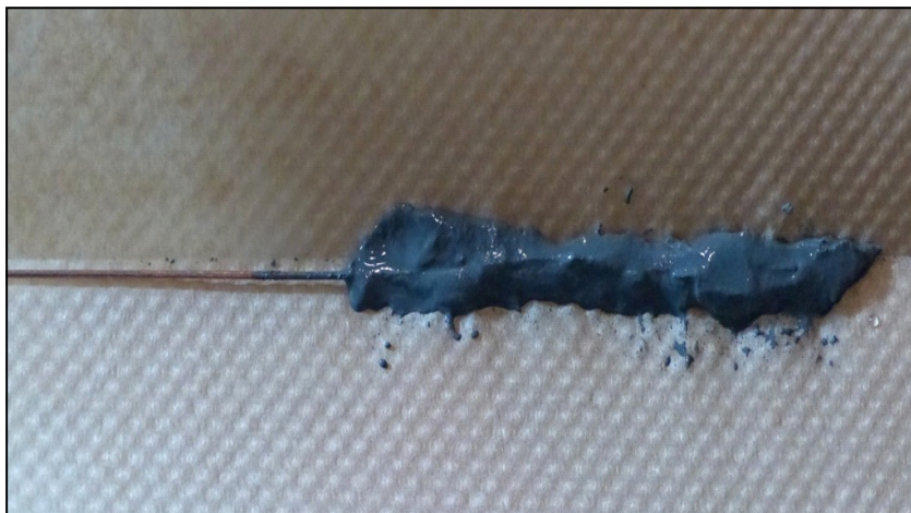
Wie oben jedoch mit eingelegtem Kupferdraht und dem Versuch die Oberfläche etwas mit Wasser am Finger zu glätten.
