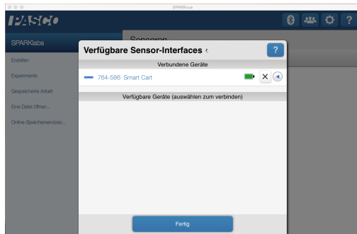
Abbildung 1: Der Smart Cart ist normal über Bluetooth mit SPARKvue verbunden. Der Propellerantrieb wird nicht angezeigt.
