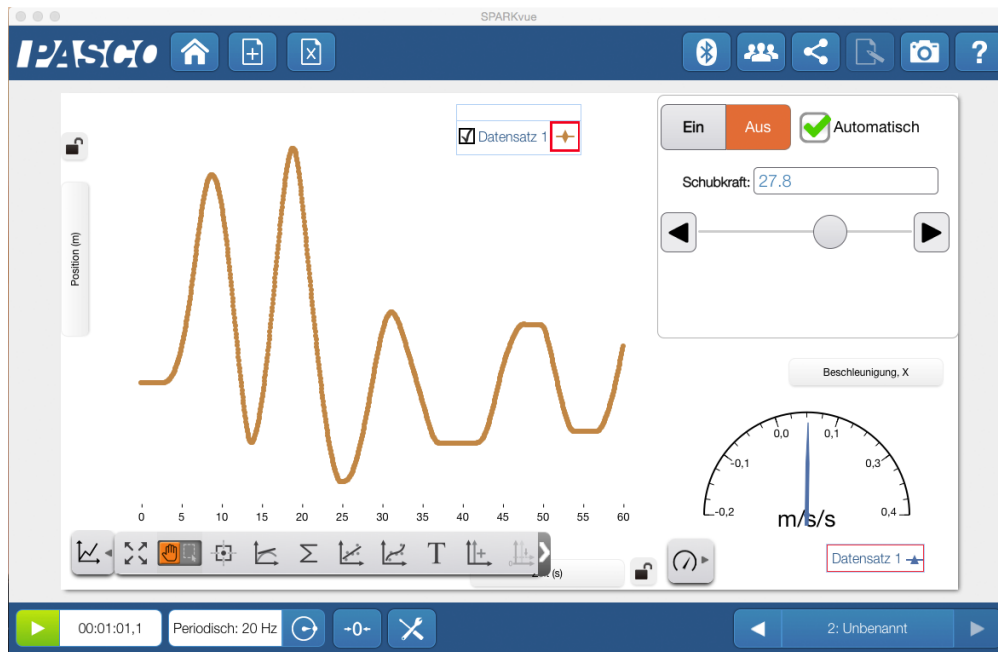
Abbildung 3: Links zeigt den zeitlichen Positionsverlauf. Rechts oben ist die Propellersteuerung und darunter die resultierende x-Beschleunigung.
