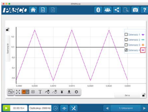
Abbildung 3: Sinusfrequenz mit Abtastrate 2f
