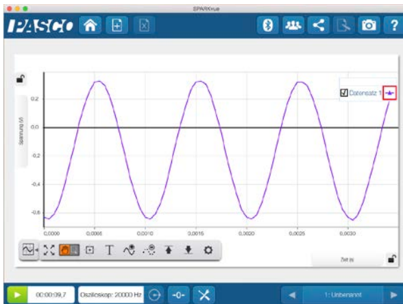
Abbildung 5: Sinusfrequenz mit Abtastrate 20f
