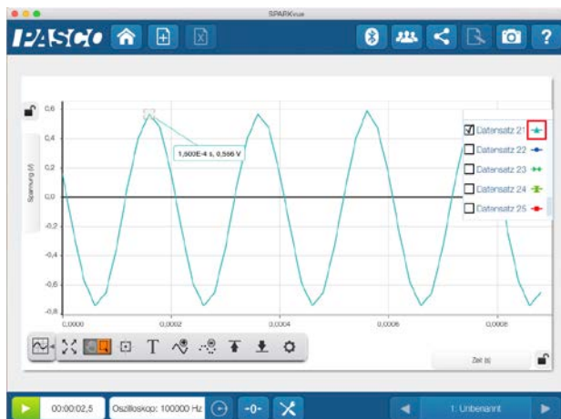
Abbildung 11: Messung der Frequenz 5kHz
