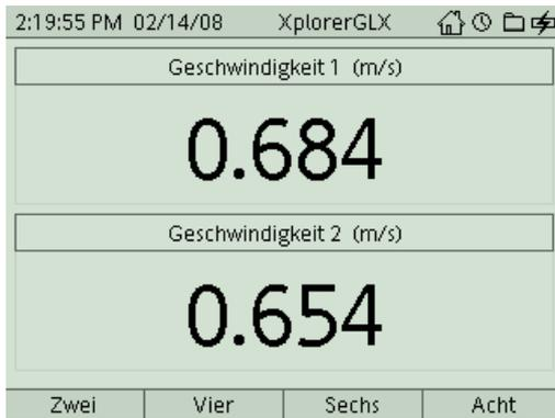
Warum sind bei doppelter Fahrzeugmasse (das Ballastgewicht hat die gleiche Masse wie der Wagen alleine) die erzielten Geschwindigkeiten eigentlich nicht genau halb so groß wie im Versuch zuvor?
