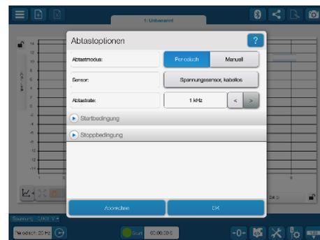
Die Frequenz wird bis zur maximalen Frequenz erhöht. Die maximale kontinuierliche Messrate beträgt 1 kHz.
