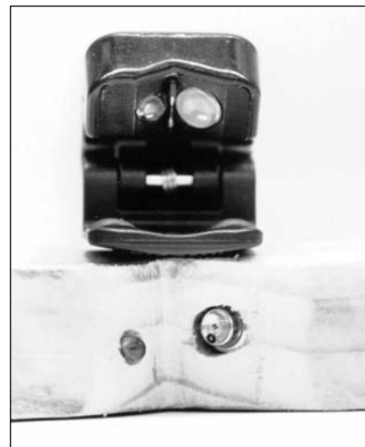
Abb. 3: Pulsmesser der Firma Dynavit (oben) und Modell (unten); jeweils mit Phototransistor (links) und Infrarotdiode (rechts)
