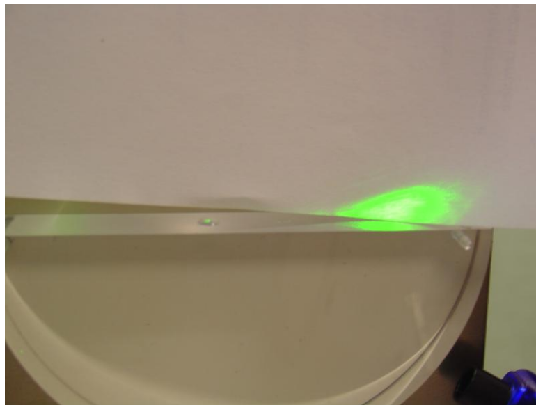
Abb.2.1 Transmittierter Lichtstrahl bei Anwesenheit eines Flüssigkeitstropfens
