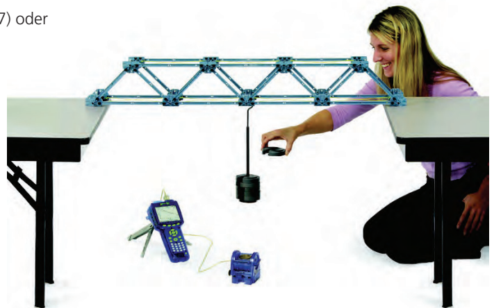
Abb. 22b Messen der Brückenbelastung mit einem Bewegungssensor
