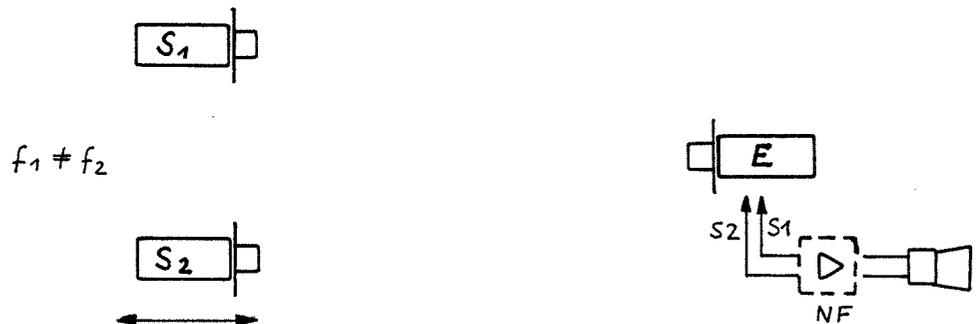
**Durchführung:** Aufbau nach Skizze. Die Frequenz des 2. Senders wird verstellt, bis über den demodulierten Ausgang (S 2) des Empfängers eine gut hörbare Schwebungsfrequenz  $\Delta f$  abgegeben wird:  $\Delta f = f_2 - f_1$ ;  $f_2 > f_1$
