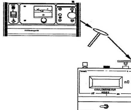
Die Gleichung  $Q = C \times V$  kann durch den Übertrag von Ladung bei verschiedenen Ausgangsspannungen verifiziert werden. Die aufgezeichnete Kurve soll linear sein.
