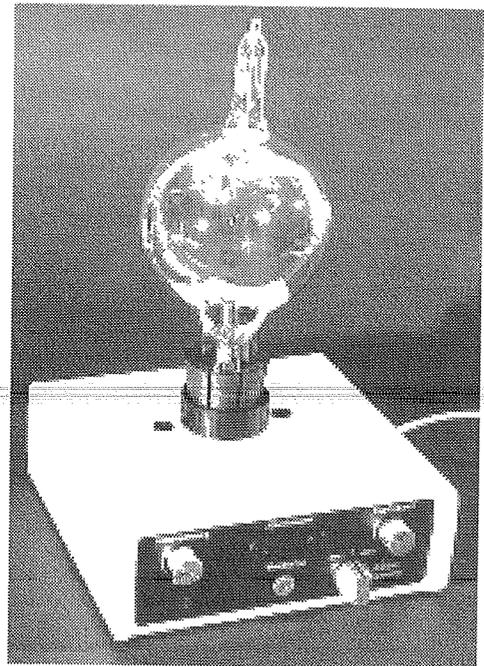
Das Grundgerät stellt alle zum Betreiben der verschiedenen Röhren notwendigen Betriebsspannungen bereit. Ein im Betriebsgerät integrierter Kippgenerator erzeugt die in Frequenz und Strahlstrom einstellbare Sägezahnspannung für die Darstellung des Verlaufs der 50Hz Netzspannung. Die elektrische Anpassung an die Röhrentypen erfolgt durch einen Umschalter und diverse Adapterkabel.
