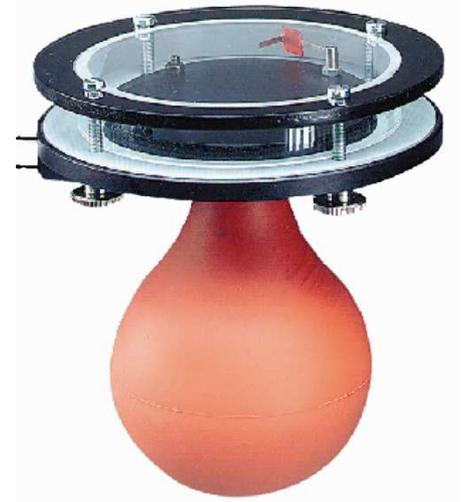
Die Übersättigung der umgebenden Luft mit Wasserdampf wird bei der Wilsonkammer durch plötzliche Entspannung und dadurch bewirkte Abkühlung des Füllgases herbeigeführt. Die Entspannung muss gleichmäßig und wirbelfrei erfolgen, um ein Verwehen der Spuren zu vermeiden.
