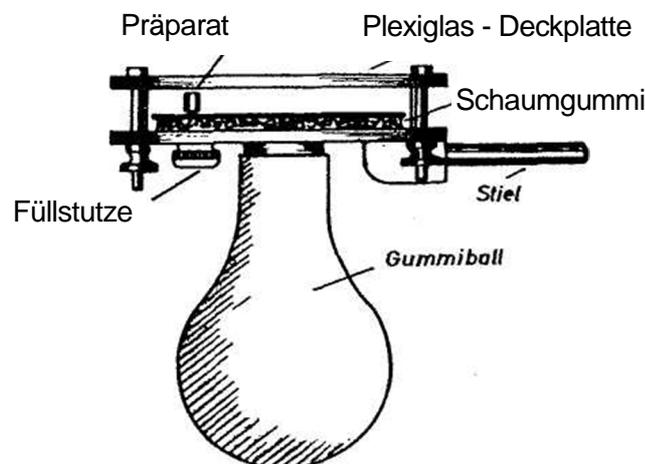
Beim plötzlichen Loslassen des Gummiballs wird sein Volumen und das der Apparatur (Kammer und Gummiball) in einem bestimmten Verhältnis zum Anfangsvolumen
