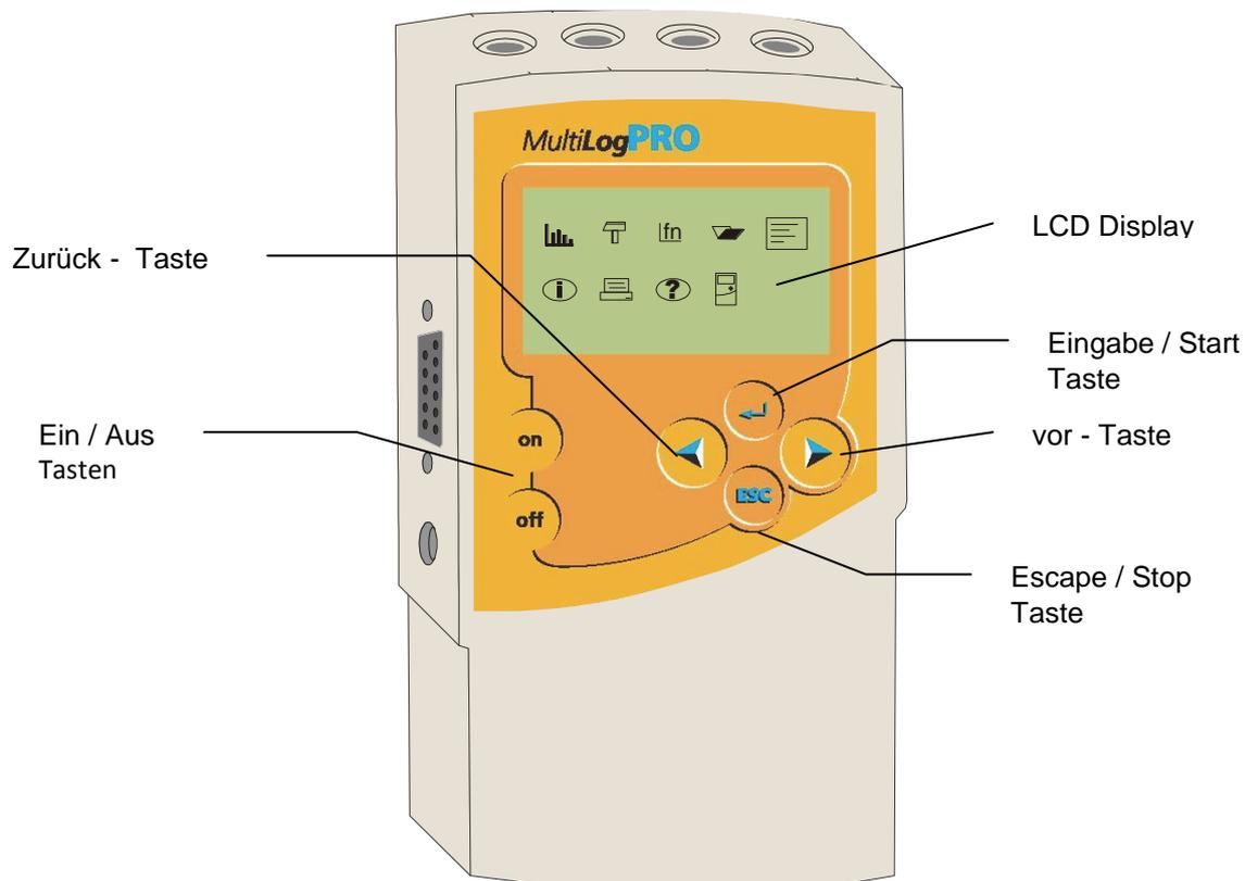
Bild 3: MultiLog Pro Frontplatte
