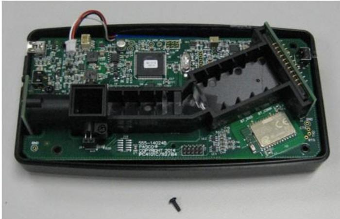
**Schritt 4b:** Heben Sie die Leiterplattenbaugruppe an der Kunststoffmitte an und legen Sie sie beiseite.
