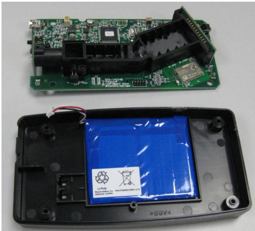
**Schritt 5:** Entfernen Sie die alte Batterie und setzen Sie die neue Ersatzbatterie an der in der Abbildung oben gezeigten Stelle ein. Setzen Sie die Leiterplatte über der Batterie wieder ein und stecken Sie die Batterie in den entsprechenden Anschluss. Bringen Sie die Kreuzschlitzschraube wieder an.
