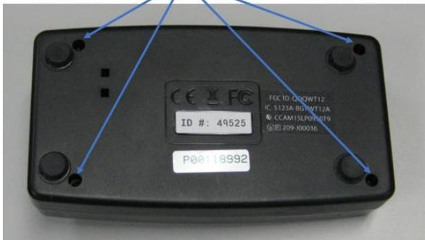
**Schritt 2:** Lösen Sie die (4) T-8-Schrauben mit einem T-8-Schraubendreher. Halten Sie die Kunststoffhälften des Spektrometers zusammen, drehen Sie das Spektrometer um und lassen Sie die (4) Schrauben herausfallen. Legen Sie das Spektrometer auf eine ebene Fläche. Die Schrauben seitlich herausdrehen und die obere Abdeckung abnehmen.
