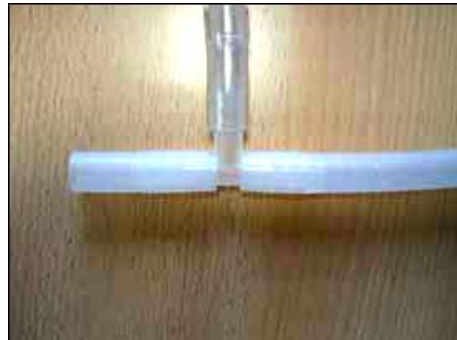
Abb. 2: Die Schlauchenden ganz aufziehen, dann die Röhre in den Halter stecken
