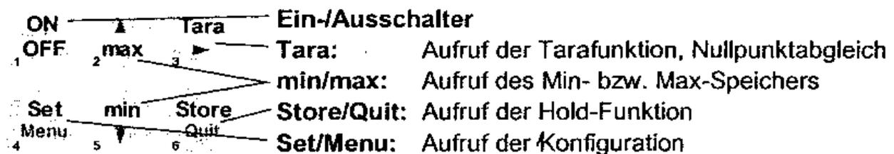
**Max-Speicher:** Die Taste 2 "max" zeigt den maximal gemessenen Wert. Erneutes Drücken blendet ihn wieder aus. Zum Löschen des Max-Wertes "max" für >2 sec. drücken.
