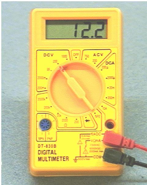
Abb. 1.1.2.1 Digitales Multimeter
