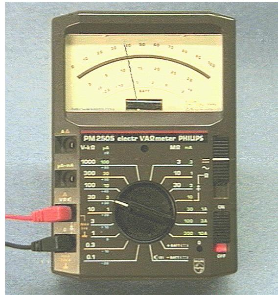
Abb. 1.1.2.2 Analoges Multimeter
