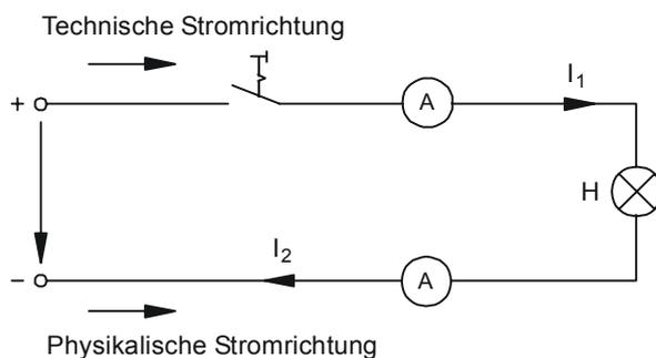
Die Richtung, in die der Strom durch die Leitungen fließt, wurde als **technische Stromrichtung** vereinbart, d.h., der Strom fließt außerhalb der Spannungsquelle vom Pluspol zum Minuspol.
