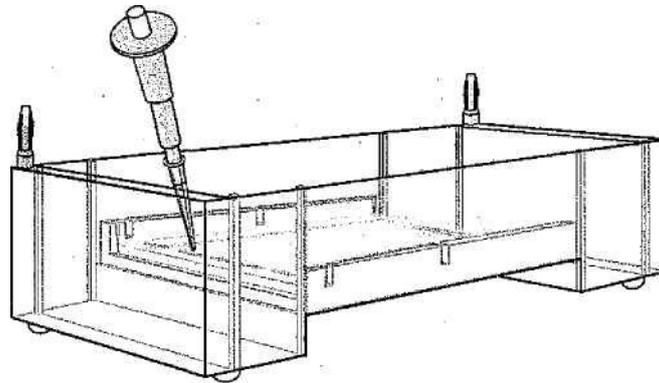
Nehmen Sie mit der Mikropipette 10 µl der DNA vom Tatort auf und pipettieren Sie diese in die erste Geltasche, wobei Sie die Pipettenspitze knapp innerhalb der Tasche halten. Passen Sie dabei auf, den Gelboden nicht zu durchstoßen.
