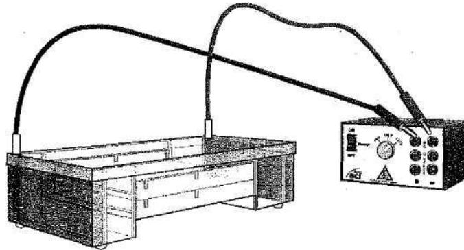
Anmerkung: Sie können an der Neo/SCI-Spannungsquelle auch eine Spannung von 50 V oder 125 V wählen. Bei niedrigerer Spannung wird die DNA langsamer im Gel aufgetrennt, bei höherer Spannung entsprechend schneller.
