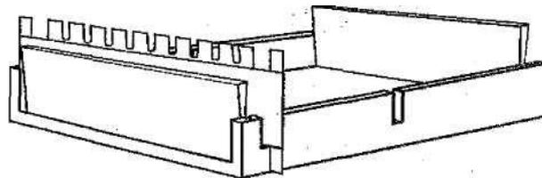
Giessen Sie die geschmolzene Agarose (55°C) vorsichtig in den Gelschlitten, sodass dieser bis zu einer Höhe von etwa einem halben Zentimeter gefüllt wird.
