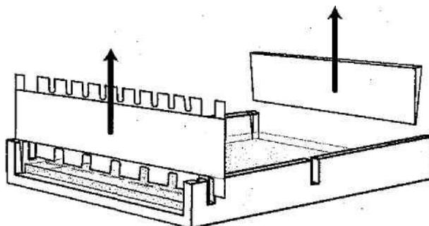
Entfernen Sie den Kamm vorsichtig, indem sie ihn langsam nach oben herausziehen. Beschädigen Sie dabei nicht die Geltaschen. Entfernen Sie die Begrenzungsschienen und legen Sie den Gelschlitten in die Mitte der Elektrophoresekammer.
