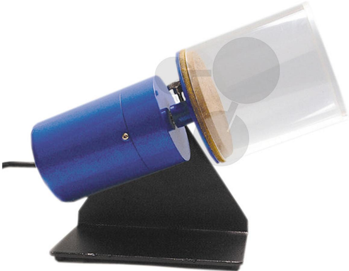
Klinostat Apparat mit Zylinderaufsatz
