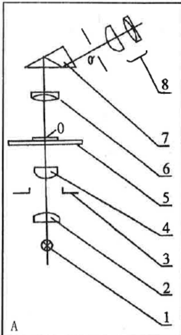
1. Das Abbildungssystem besteht aus Objektiv (6), Prisma (7) und Okular (8). Die Objektive (6) vergrößern in erster Linie die betrachteten Objekte ((0), wobei die Lichtstrahlen durch das Prisma (7) bis 45 ° gebrochen werden. Das betrachtete Objekt wird vergrößert durch die Okulare (8) wahrgenommen.
