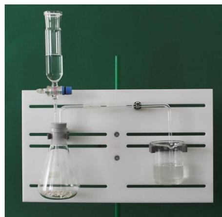
b. Aufbau eines galvanischen Elements
