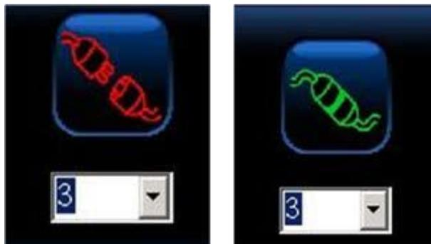
**Tip: Es wird nichts passieren, bevor Sie auf das Verbindungs-Symbol klicken und die darunter liegende Zahl auswählen, die die Kommunikationsport-Nummer des regenerativen Energiemonitors darstellt. Beziehen Sie sich auf den Abschnitt "Nähere Details" für eine nähere Erklärung.**
