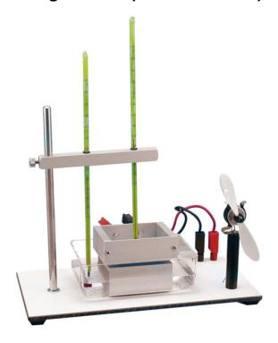
Herzstück des Gerätes ist ein Peltierelement, bestehend aus 144 kleinen Halbleiterquadern, die zwischen zwei Keramikplatten eingeschlossen sind.
