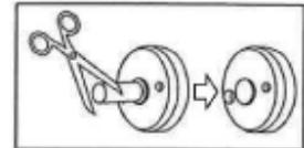
3. Den zweiten Gummistopper nach Zeichnung in das Gehäuseinnenteil stecken. Mit einer Spitzzange den Stopper plazieren
