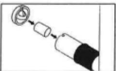
8. Schalterknopf in die Aussparung des Gehäuseaußenteils legen.
