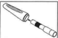
10. Linse mit der gewölbten Seite nach außen vorne aufsetzen und mit dem Verschluss befestigen.
