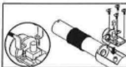
6. LED in die LED-Fassung im Gehäuseinnenteil stecken. Darauf achten, dass die abgeflachte Seite der LED zur abgeflachten Seite der Fassung ausgerichtet ist.
