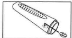
9. Gehäuseaußenteil in der Position wie in Schritt 8 beschrieben halten und das Gehäuseinnenteil vorsichtig in das Gehäuseaußenteil drehen bis es vollständig hinein passt.
