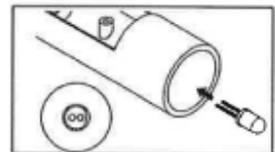
7. Magnet in das Gehäuseinnenteil stecken und das Gehäuseinnenteil mit der Endkappe verschließen.
