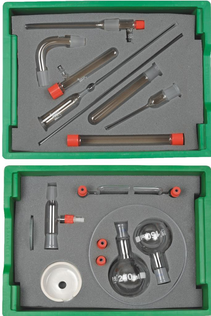
Dieses Kit enthält alle wesentlichen Glaselemente, die für die schnelle Herstellung von Gasen im Labor benötigt werden, einschließlich Ammoniak, Brom, Kohlendioxid, Kohlenmonoxid, Chlor, Wasserstoff, Bromwasserstoff, Jodwasserstoff, Chlorwasserstoff, Schwefelwasserstoff, Wasserstoffperoxid, Stickstoffoxid, Stickstoff, Stickstoffdioxid, Stickstoffoxid, Sauerstoff, Schwefeldioxid, Schwefeltrioxid usw.
