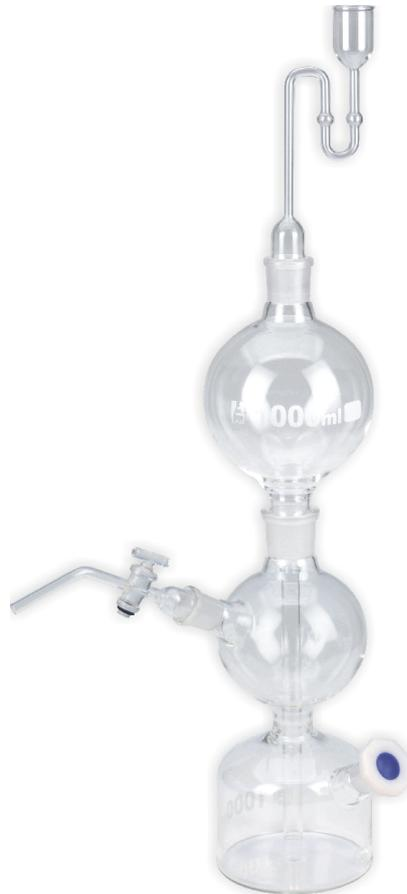
In Laboratorien wird häufig eine kontinuierliche Versorgung mit bestimmten Gasen auf Abruf benötigt. Der Gasgenerator von Kipp kann diese Dienstleistung für viele Gase, einschließlich Wasserstoff, Schwefelwasserstoff und Kohlendioxid, erbringen.
