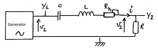
Der Funktionsgenerator liefert eine sinusförmige Spannung U1.
