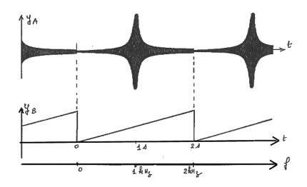
Um eine stehendes Bild zu erzielen, muss man das Oszilloskop durch yB synchronisieren. Falls man ein digitales Oszilloskop verwendet, oder eine computergestützte Aufzeichnung, ist es möglich, dass sich bei bestimmten Punkten Anomalien in der Kurve yA(t) zeigen, die auf einen stroboskopischen Effekt zurückzuführen sind. Dieser Effekt kann auftreten, wenn die Frequenz des Generators einen Wert annimmt, der in einer einfachen Beziehung zur Wiederholfrequenz des Oszilloskops steht.
