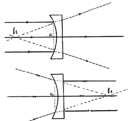
reeller Brennpunkt genannt. Die Brennweite ist gleich dem Abstand zwischen reellem Brennpunkt und der Linsenmitte.
