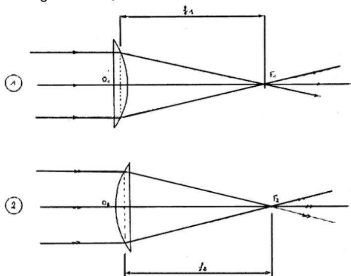
Parallel zur optischen Achse fallende Lichtstrahlen werden im Brennpunkt gesammelt.
