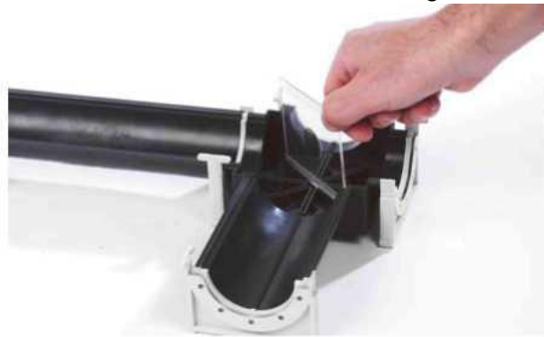
Einsetzen des Spiegels \varnothing 20 mm in 45^\circ Position der optischen Achse (verwenden Sie die Rillen am Boden des Teleskopteils)
