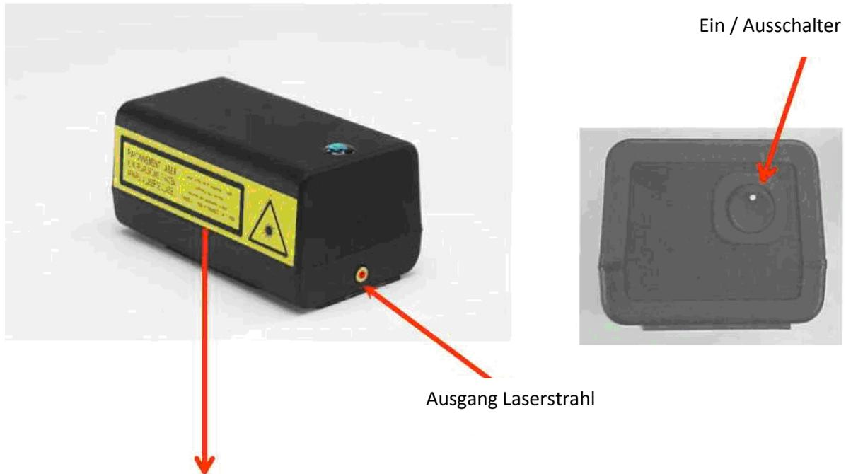
Laserstrahlen                      Laser 650 nm, Leistung < 1 mW
