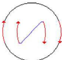
Man sieht von vorn auf die Spule entsprechend ihrer Achse; wenn der Strom entgegen dem Uhrzeigersinn fließt, kann man den Buchstaben N wie Nord erkennen; wenn der Strom im Uhrzeigersinn fließt, kann man den Buchstaben S wie Süd erkennen.
