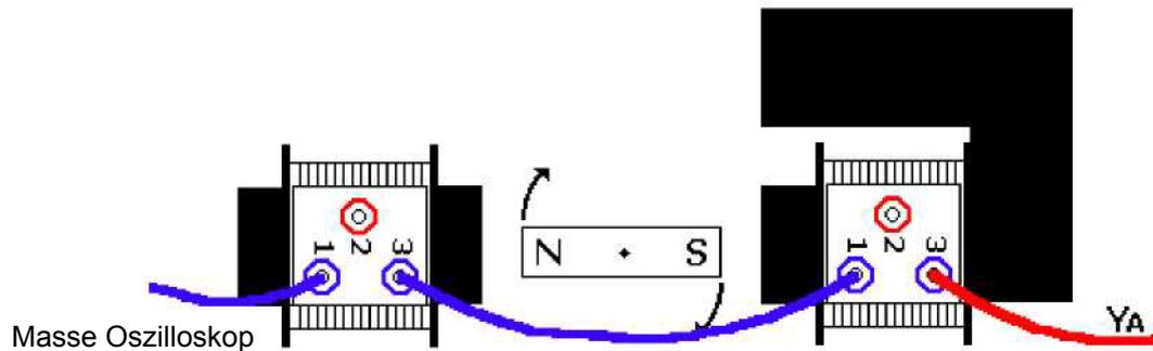
Bei einer gegebenen Rotationsgeschwindigkeit des Magneten verdoppelt sich somit die Spannungsfrequenz.
