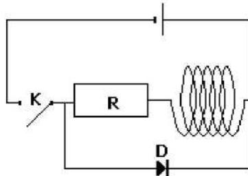
Wenn der Schalter K eingeschaltet wird, fließt über die selbstinduzierte EMK ein selbstinduzierter Strom, der sich der Abschaltung des Dauerstroms widersetzt; die Diode wird also leitend, was zur Folge hat, dass die Überspannung an den Klemmen der Spule abgebaut wird.
