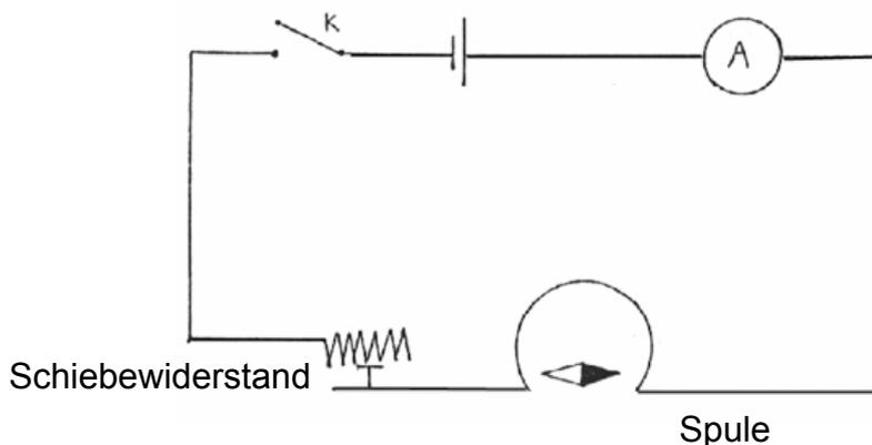
b) Die Grundplatte wird mit Eisenfeilspänen bestreut. Zusätzlich setzt man eine Magnetnadel darauf. Man lässt einen Strom von  $I = 6$  bis  $10$  A durch die Spule fließen und rüttelt den Sockel leicht, damit sich die Eisenfeilspäne ausrichten.
