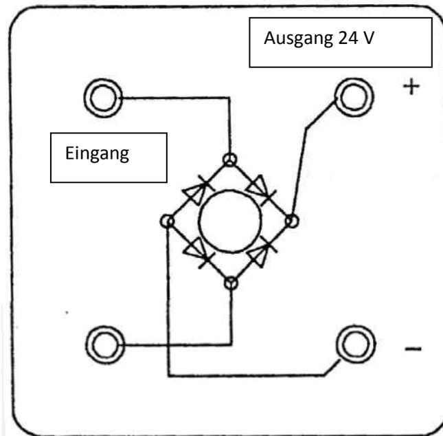
Fig.3 Modul Brückengleichrichter
