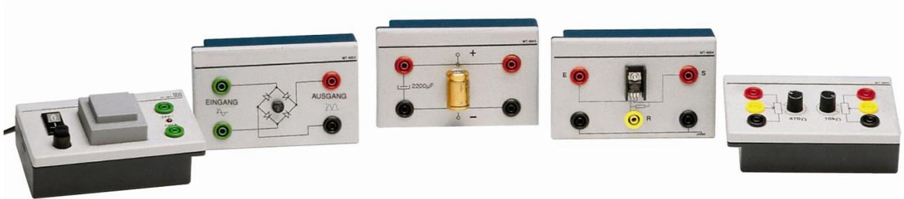
Mit Hilfe der hier vorgestellten Geräte kann man ein stabilisiertes Netzteil zusammen-bauen und seine Funktionsweise untersuchen.
