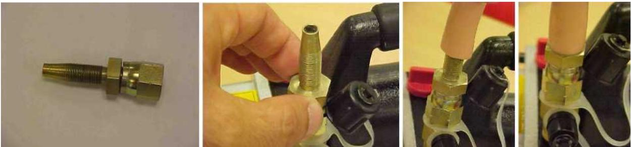
3- Führen Sie das geriffelte Anschlussstück in die Leitung ein und stülpen Sie die Leitung vollständig darüber, um die Dichtheit zu gewährleisten.
