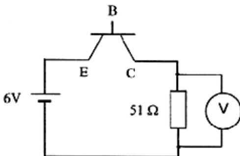
Wenn man den Fototransistor beleuchtet, gibt es einen Strom im Widerstand; die Spannung an den Anschlussklemmen des Widerstands kann an einem Voltmeter abgelesen werden.
