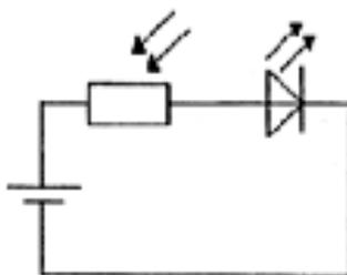
Wenn man die Fotodiode beleuchtet, leuchtet die LED-Diode auf. Falls man den Lichteinfall auf die Fotodiode verhindert, erlischt auch die LED-Diode.
