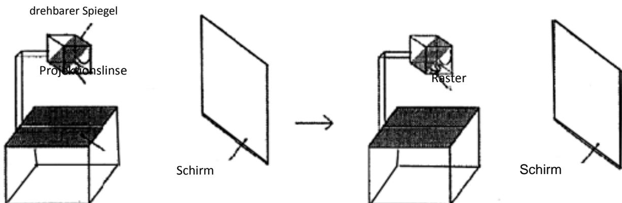
Ein klares Bild durch den Schlitz erzielen und das Raster in die korrekte Richtung auf die Projektionslinse lenken
