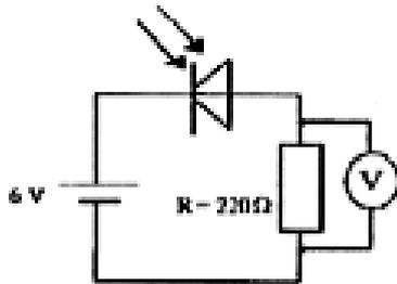
Wenn man die Fotodiode beleuchtet, fließt Strom im Widerstand und es ist eine Spannung, die nicht gleich null ist, an den Widerstandsklemmen, festzustellen.
