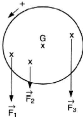
Ich hänge nun eine dritte Masse, z.B. 20 g an einen Punkt der Scheibe. Die anderen beiden Massen bleiben in Position. Die Massen  $m_1, m_2, m_3$  üben die Kräfte  $\vec{F}_1, \vec{F}_2, \vec{F}_3$  aus und ich rechne  $M_G(\vec{F}_1), M_G(\vec{F}_2),$
