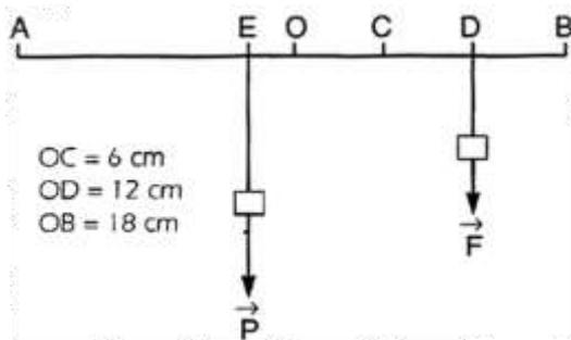
10. Ich realisiere das Gleichgewicht des Stabs, indem ich Kräfte  $\vec{F}_1$ ,  $\vec{F}_2$ ,  $\vec{F}_3$ , sukzessiv auf C, D und B einwirken lasse, Kräfte, die ich mit Hilfe des Dynamometers messe.
