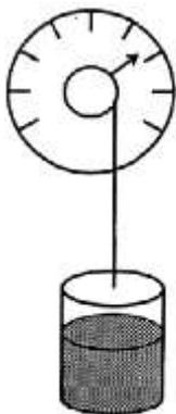
9. Um das Gewicht zu bestimmen, fülle ich das Reservoir bis zum Wert  $h_1$  auf (bei  $7^\circ$ ).
