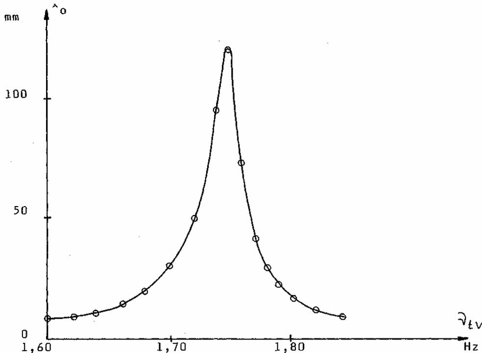
**4. Experiment:** Resonanzfrequenzen für das gekoppelte System, Feder mit Belastung.
