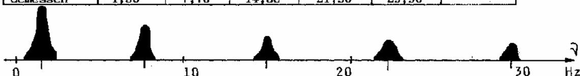
**5. Experiment:** Interferenz zwischen Wellen, *ohne* Federbelastung, Analogie Akustik: **Resonanz im halboffenen Rohr.**
