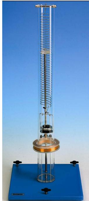
Mit dem Apparat lässt sich eine zusammenhängende Serie von Übungen über mechanische Schwingungen mit großer messtechnischer Genauigkeit ausführen. Es ist leicht, eine Reihe von longitudinalen Wellenphänomenen als Interferenz und Wellen hervorzubringen, und deren Gesetzmäßigkeiten nachzuweisen.
