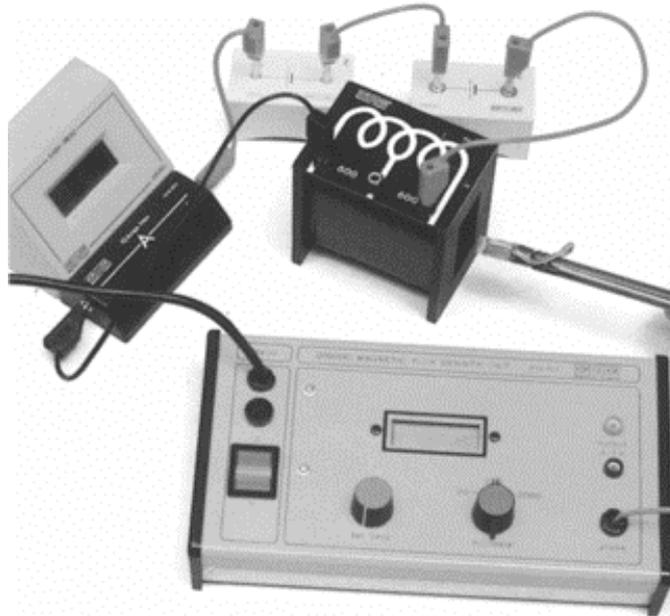
Das Gerät verfügt über eine eingebaute 3 1/2stelliger LCD-Anzeige und einen zusätzlichen Ausgang 0..1 V ( $R_i > 100 \text{ k}\Omega$ ) zum Anschluss externer Messgeräte.
